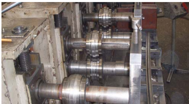
Рис. 3.16. Станок ГПС-350 М6 с технологической оснасткой для изготовления профиля 30,5×12,8×2 мм
