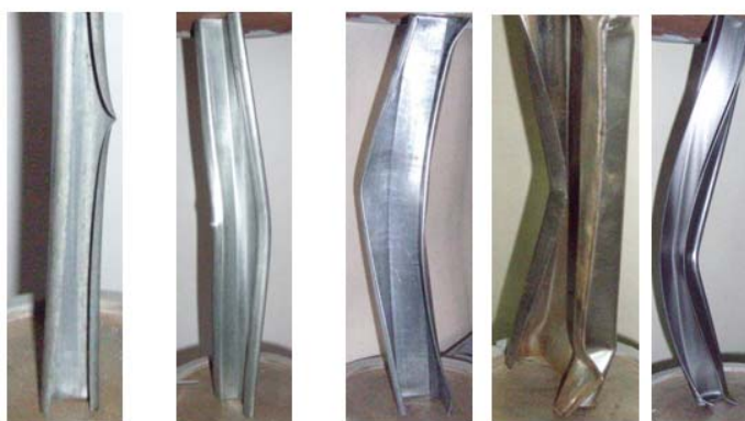
Рис. 3.22. Виды локальной потери устойчивости элементов профилей с отбортовками при аксиальном сжатии
