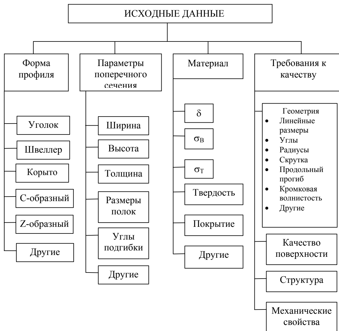
Рис. 4.1. Исходные данные профиля для анализа технологичности
